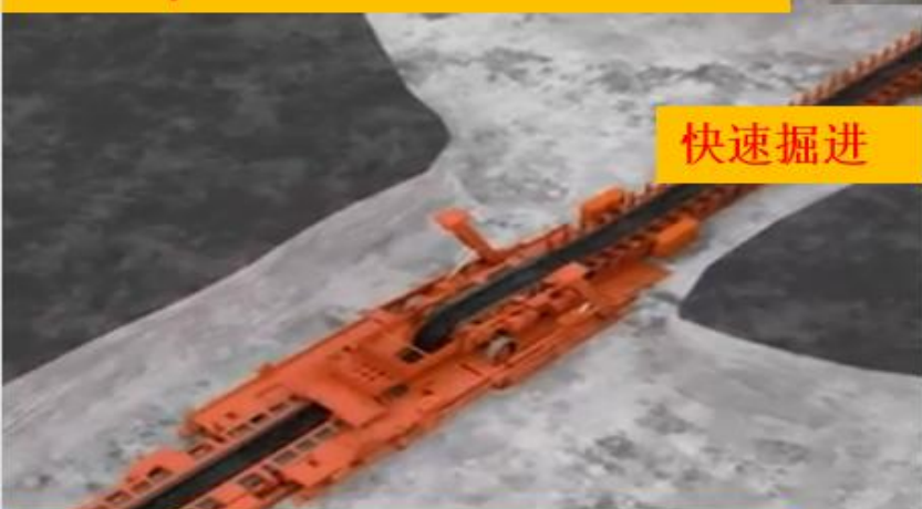
连续运输系统-伸缩式皮带输送机
